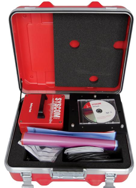
Kit standard MR3000C avec mallette de transport, câbles et bloc batterie
