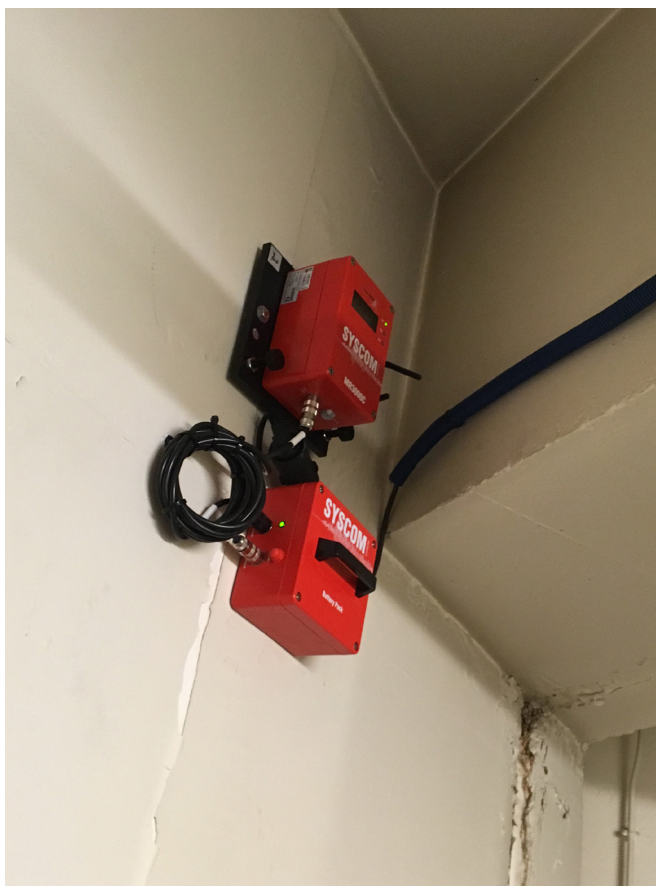
Obrázek 3 - MR3000C instalované na různých místech v sektoru T2A: na stěnu skladu, ve svislé poloze (a); na nosné zdi uvnitř budovy, ve svislé poloze (b) a na základně budovy, v horizontální poloze (c).
