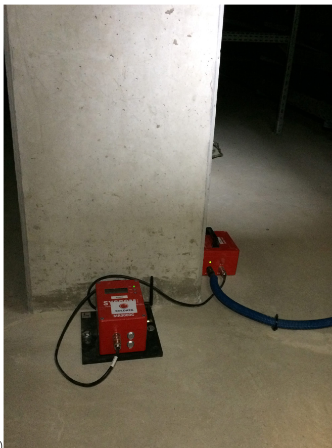
Obrázek 3 - MR3000C instalované na různých místech v sektoru T2A: na stěnu skladu, ve svislé poloze (a); na nosné zdi uvnitř budovy, ve svislé poloze (b) a na základně budovy, v horizontální poloze (c).
